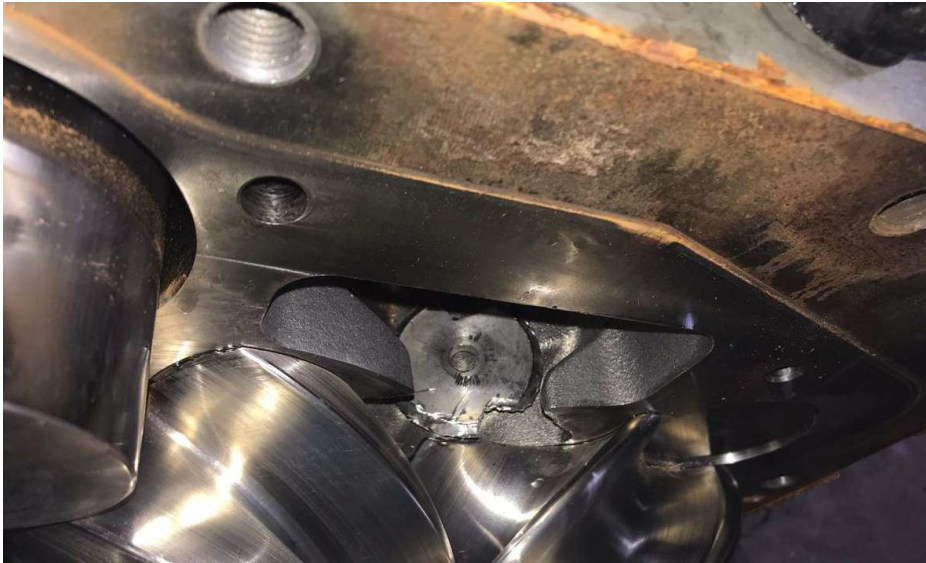
Σπασμένο αντεπίστροφο κατάθλιψης και ζημιά στους ρότορες
