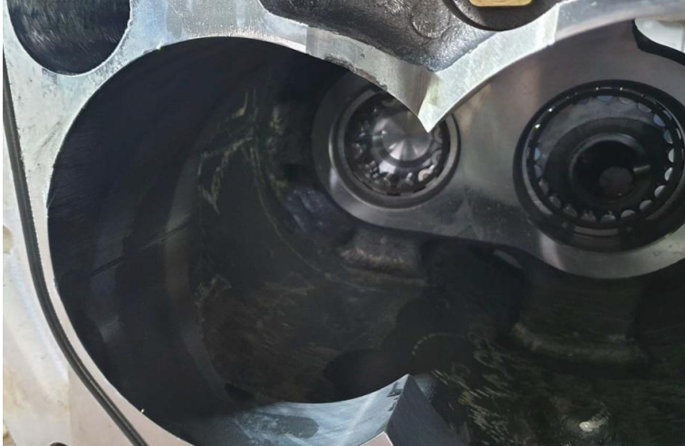
Ρουλεμάν αρσενικού και θηλυκού ρότορα με εκτεταμένη φθορά
